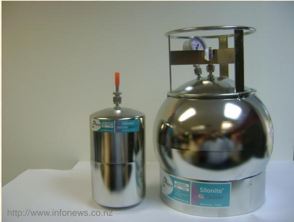
Pojemniki stalowe na próbki gazu
